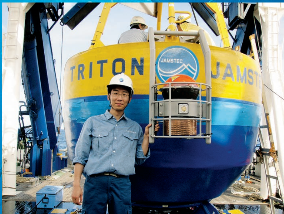
中野善之博士と JAMSTEC の大型観測装置であるトライトンブイに取り付けられた漂流ブイ (二酸化炭素分圧観測装置)。
